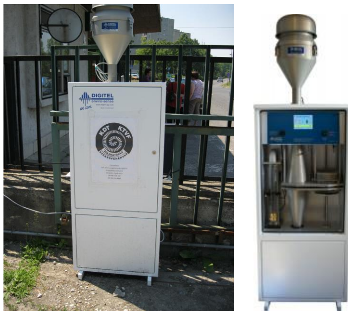
3. ábra: az indikatív mérésekre mérésre alkalmazott mintavevő berendezés
