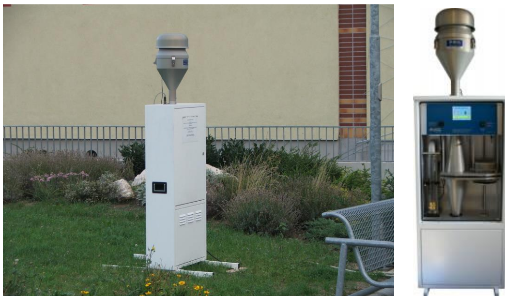
5. ábra: Várpalota, az indikatív mérésekre mérésre alkalmazott mintavevő berendezés
