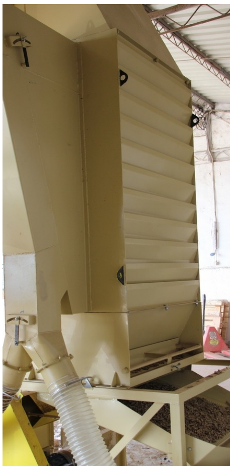
A hűtő és a szortírozó berendezés a pellet prés tartozékai
