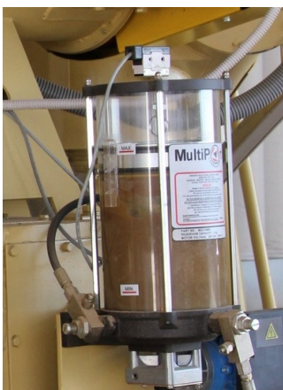
Automata zsírozó berendezés
