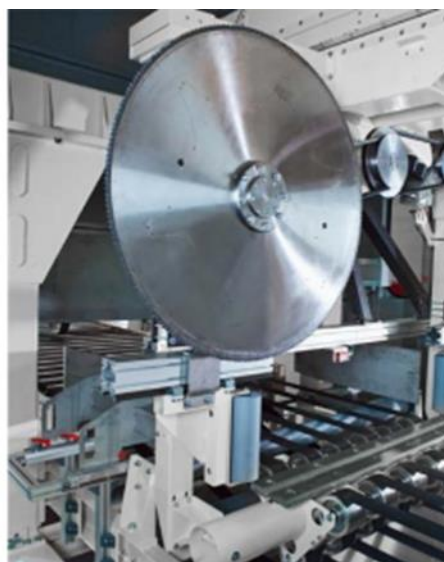
Keresztvágó fűrés (darabolás)
