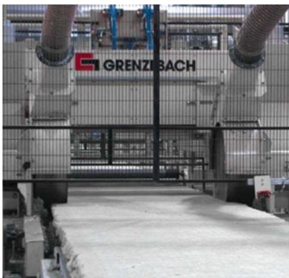
Hosszvágó fűrés (szélek levágása)
