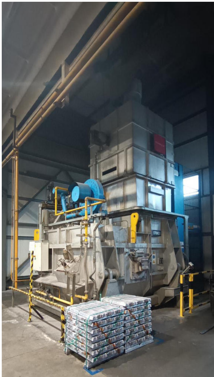
2. kép: Striko I. alumínium olvasztására szolgáló gáztüzelésű kemence a VS1 területén
