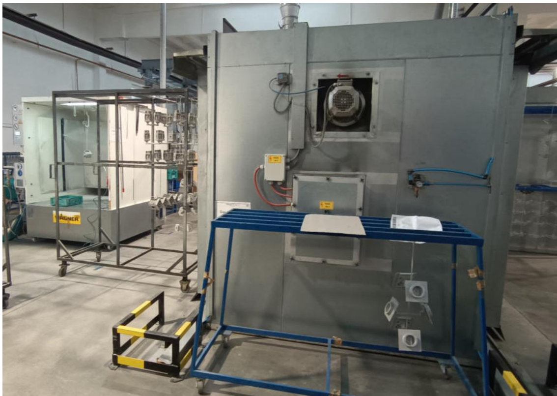
8. kép: Elektrosztatikus porfestő kabin és beégető kemence a VS2 területén
