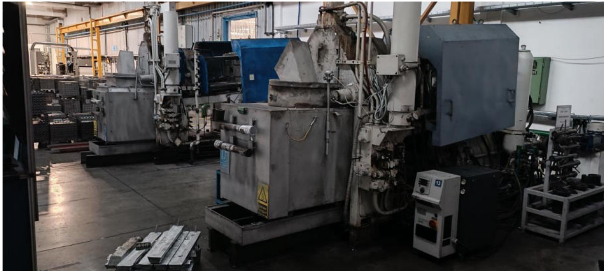
3. kép: Horganyöntő gép és elektromos fűtésű kemence a VS1 területén
