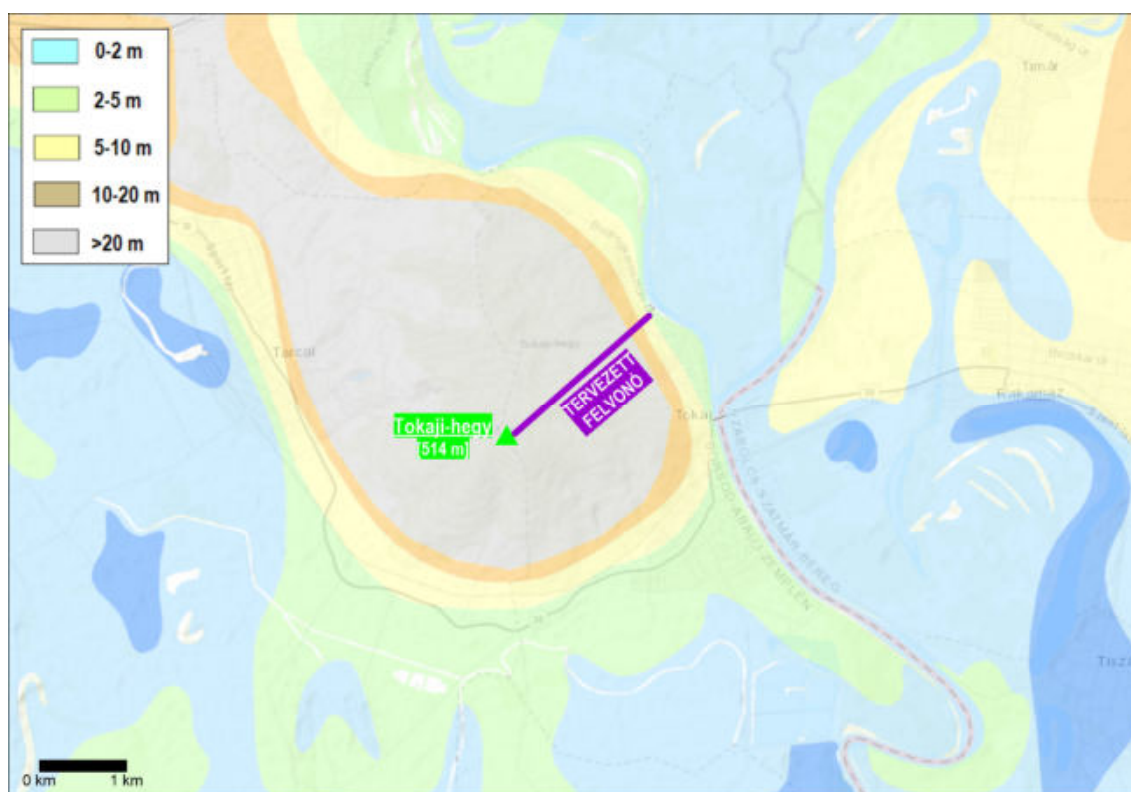
17. ábra: A Tokaji-hegy, illetve a tervezett felvonó nyomvonalának térségében a talajvíztükör felszín alatti elhelyezkedése (MBFSZ, 2022)
