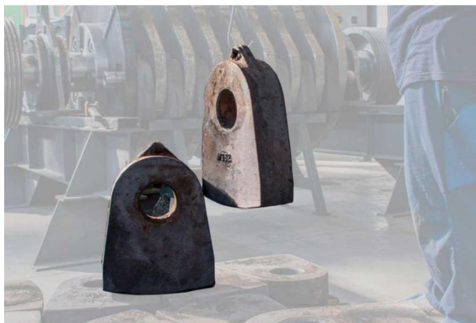
5.számú fotó: PANIZZOLO MEGA 725 gép kalapácsai
