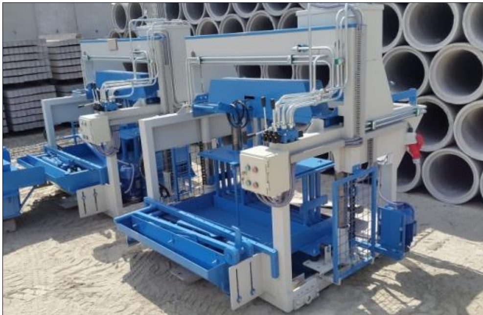
4. ábra: Betonelemgyártó gép (VP5-DSH/3S)
