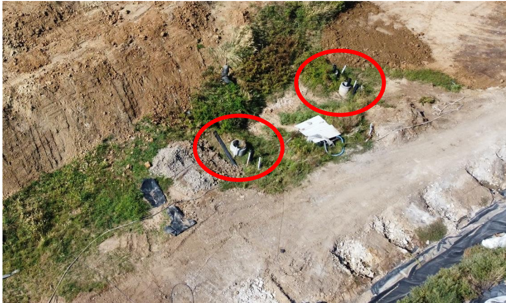
10. ábra: Csurgalékvíz gyűjtő, -ellenőrző, valamint biztonsági szivárgó drének kivezetései (2024. augusztus)
