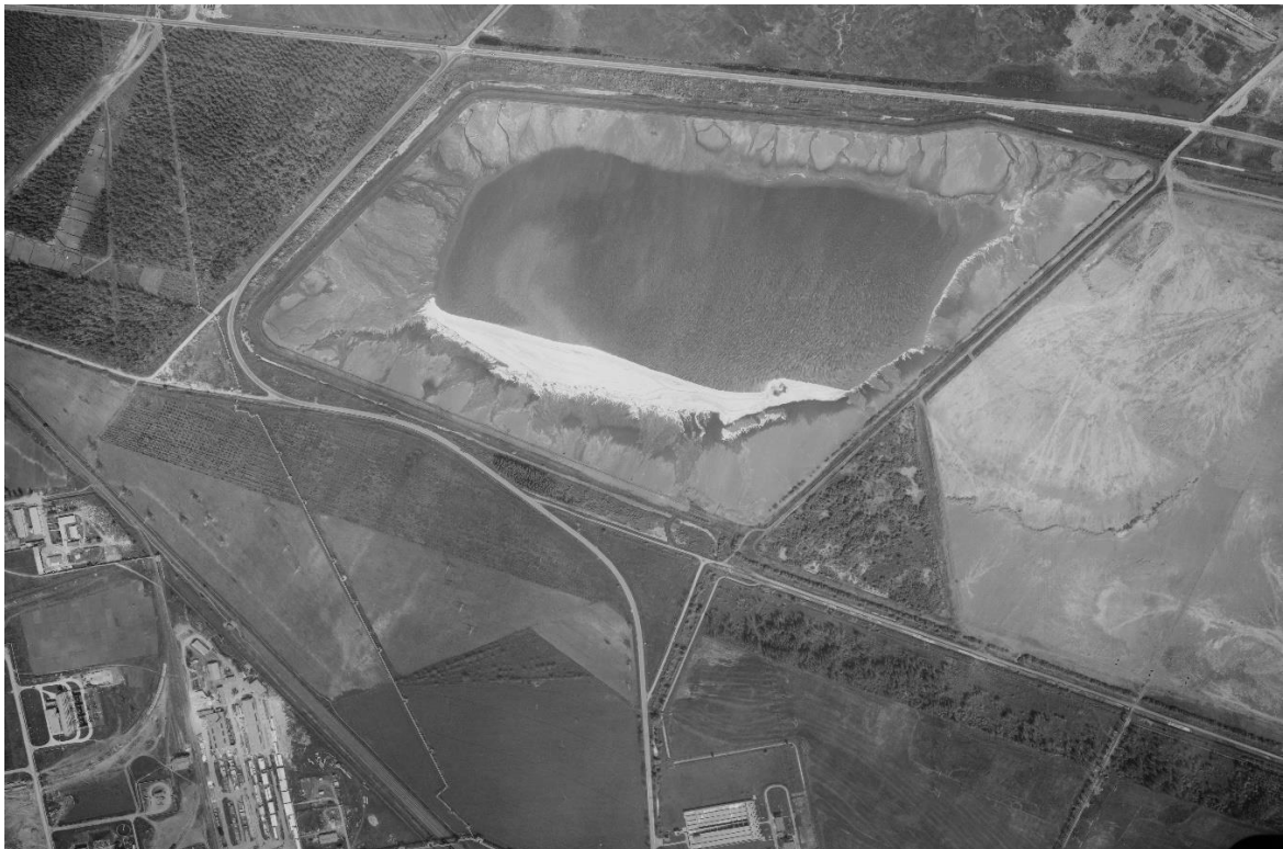
2. ábra, még ebben az évben (1961) elkészült a nyugati körtöltés is, ezzel a zagytér befogadó kapacitása a duplájára nőtt. A képen jól látszanak a körtöltés építéséhez használt kubíkgödrök. Az alsó kép 1972-ben készült és jól látszik, hogy tíz év alatt a zagytér keleti fele már megtelt, míg a nyugati rész pedig kb. félig. Jól látható a későbbi szennyvíziszap lerakó ún. háromszög kazettája is, amelyet a keleti részből választottak le.
