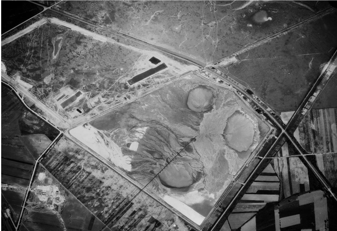
2. ábra, még ebben az évben (1961) elkészült a nyugati körtöltés is, ezzel a zagytér befogadó kapacitása a duplájára nőtt. A képen jól látszanak a körtöltés építéséhez használt kubíkgödrök. Az alsó kép 1972-ben készült és jól látszik, hogy tíz év alatt a zagytér keleti fele már megtelt, míg a nyugati rész pedig kb. félig. Jól látható a későbbi szennyvíziszap lerakó ún. háromszög kazettája is, amelyet a keleti részből választottak le.
