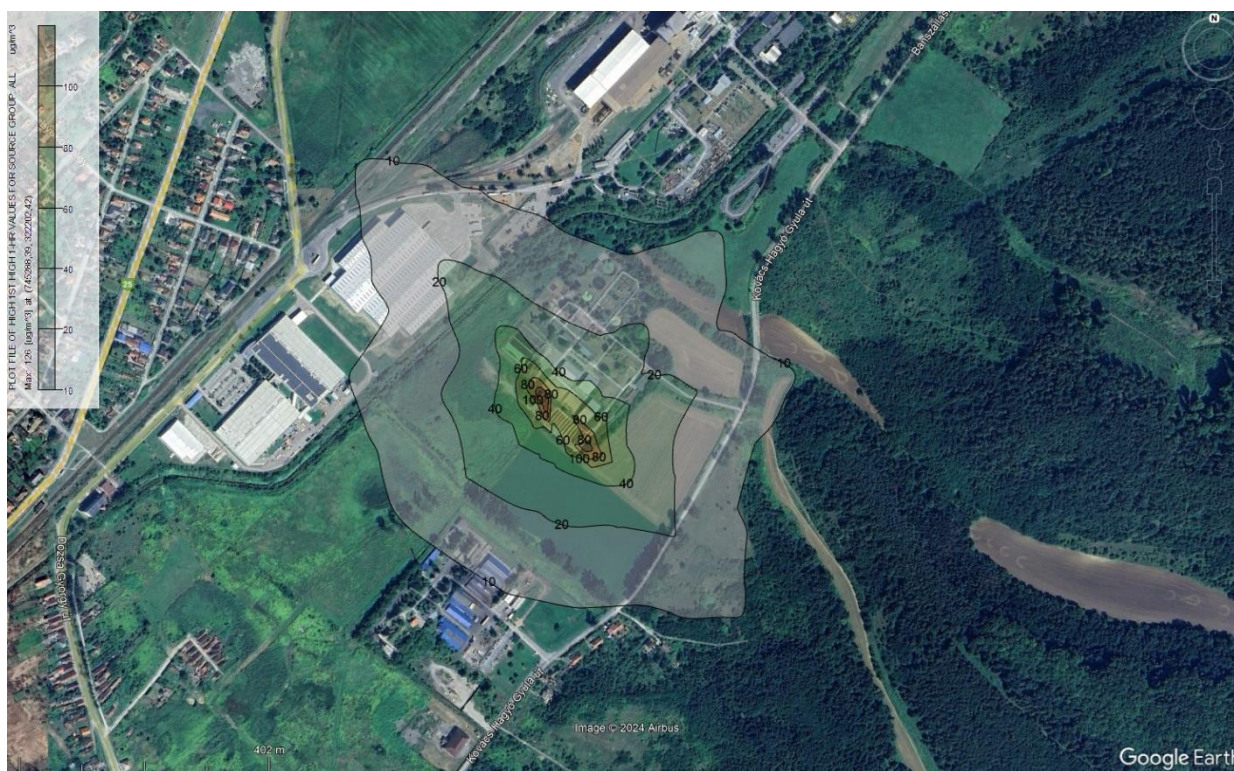
16. ábra: A CO várható legnagyobb órás környezeti koncentrációja a tevékenység végzésének következtében
