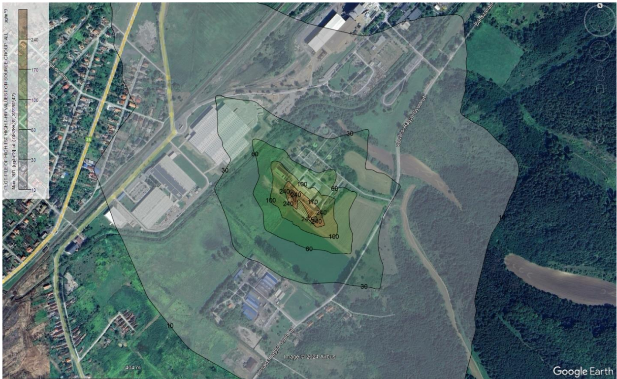
21. ábra: A metán várható legnagyobb órás környezeti koncentrációja a tevékenység végzésének következtében
