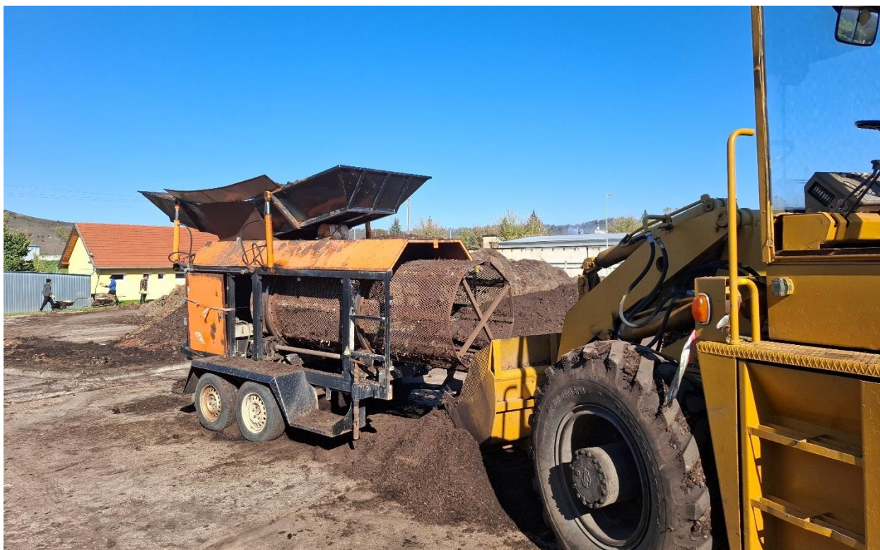
10. ábra: A komposzt rostálásához használt berendezés
