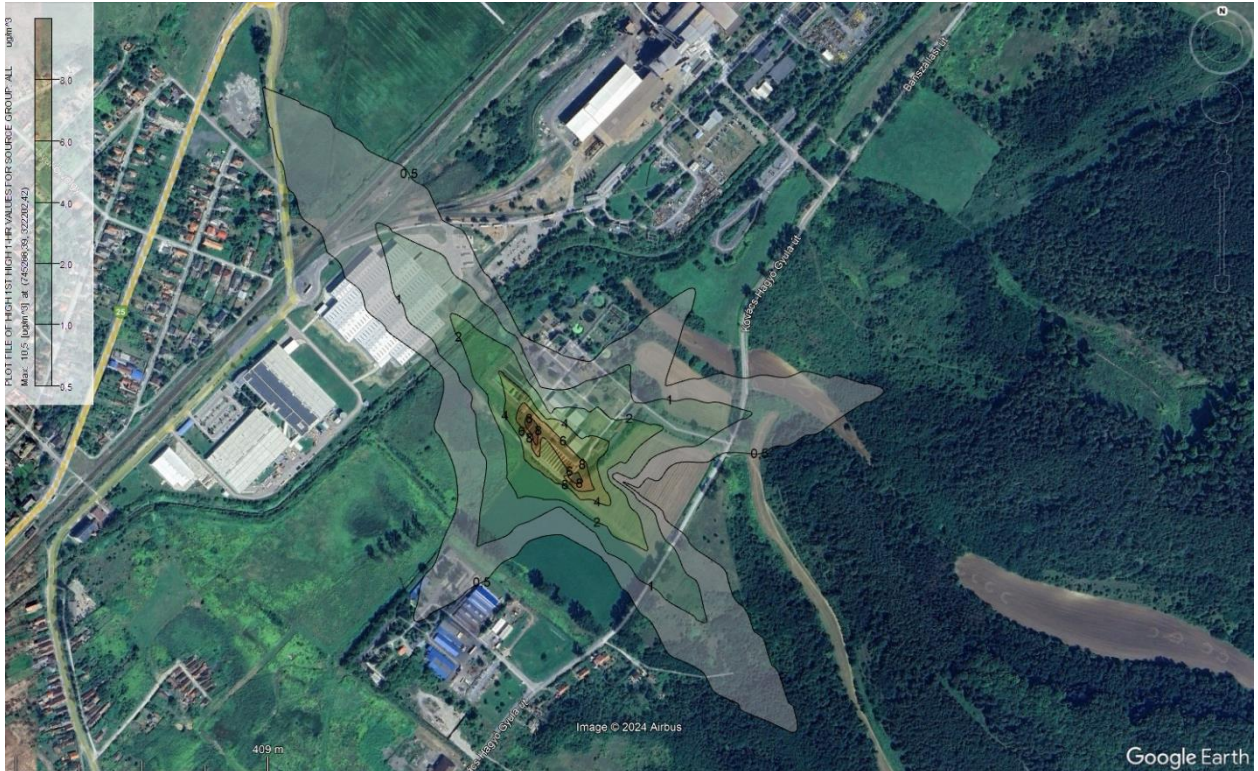
17. ábra: A \text{NO}_2 várható legnagyobb órás környezeti koncentrációja a tevékenység végzésének következtében
