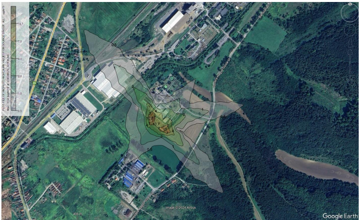
18. ábra: A \text{PM}_{10} várható legnagyobb 24 órás környezeti koncentrációja a tevékenység végzésének következtében
