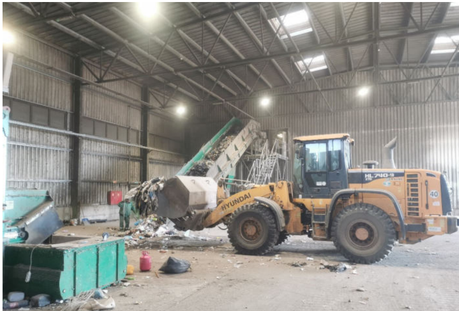
4. kép: A hulladék feladása a technológiai sorra (2025. február)
