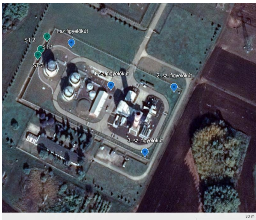
7. ábra –A telephely monitoring kútjai és talajvizsgáló pontjai
