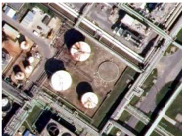
Az MF-504A/B és MF-505 tartályok a 2023. évi ortofotón. Az „üres” alapon épül a MF-506
