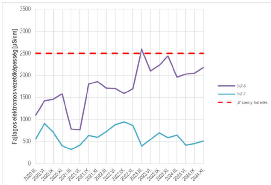
26. ábra: A monitoring kutak vizének fajlagos elektromos vezetőképessége 2020-2024. években
