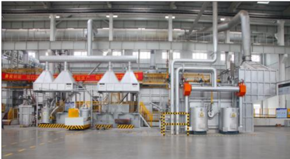
23. ábra: Gázmentesítő gép és munkaterület az olvasztóműhelyben
