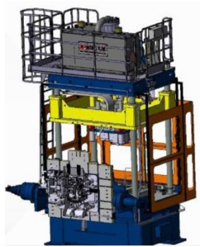
29. ábra: Automatikus vágógép (állítható kiválású, a levágott anyag visszaforgatására)
