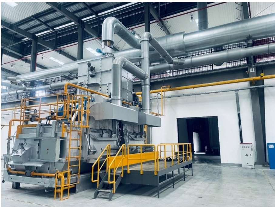
22. ábra: Központi olvasztókemencés rendszer az olvasztóműhelyben
