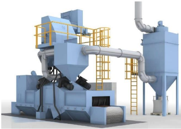
31. ábra: présöntött termék szemcsesörás (golyósörás) és porleválasztó berendezésének illusztrációja
