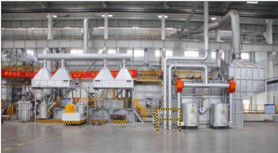
23. ábra: Gázmentesítő gép és munkaterület az olvasztóműhelyben
