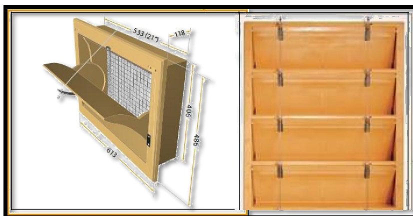
Légbeejtők felépítése
