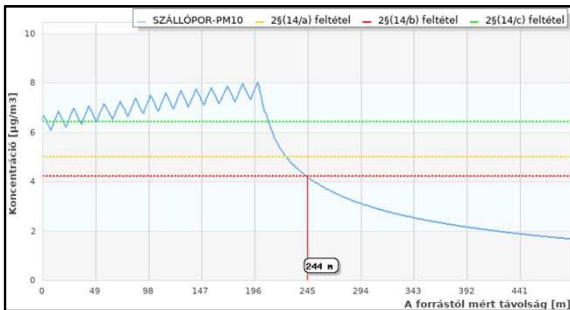
L4. ábra Légszennyezés-terjedés jellemző értékei szilárd légszennyezőre
