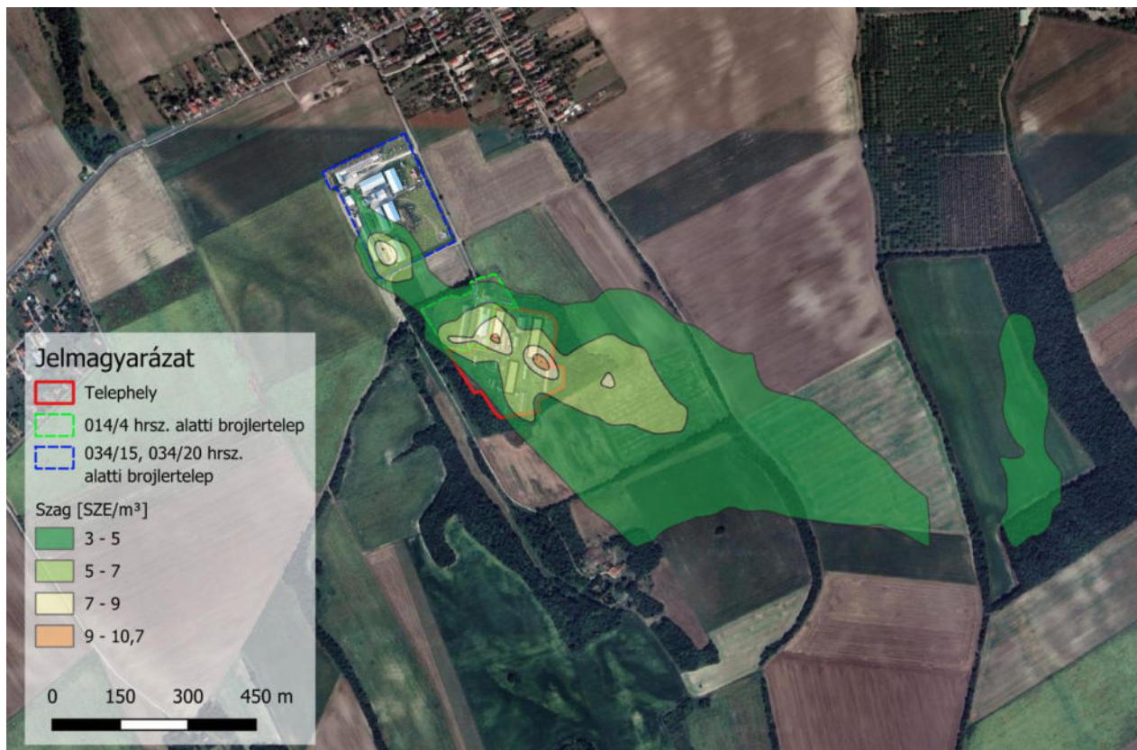
11. ábra A brojlertelepek együttes szagkibocsátása – terjedési kép
