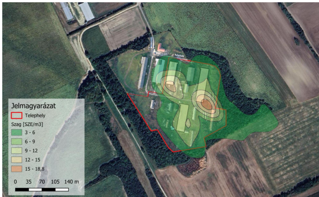
8. ábra Szagkibocsátás terjedési képe
