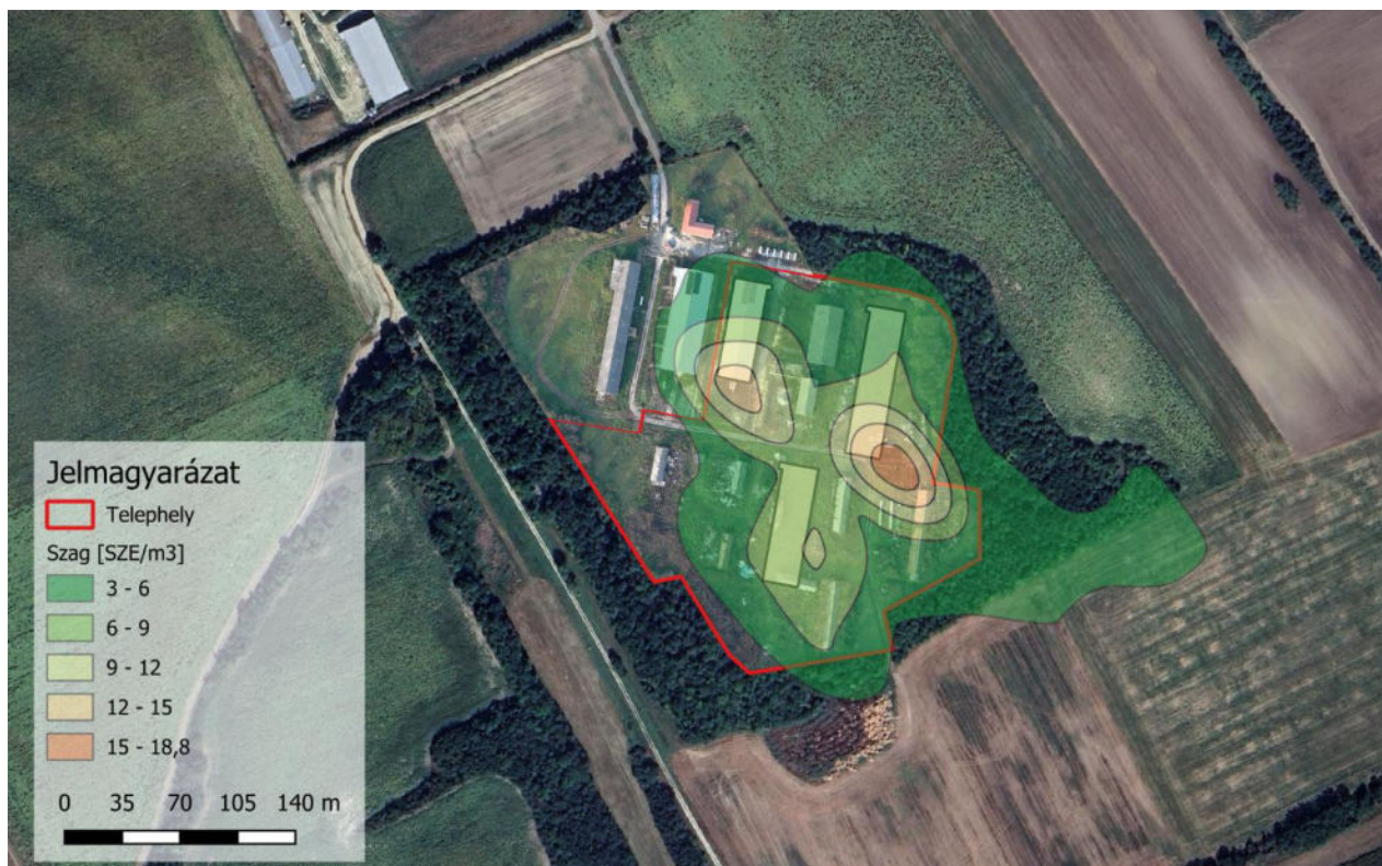
4. ábra Szagkibocsátás terjedési képe
