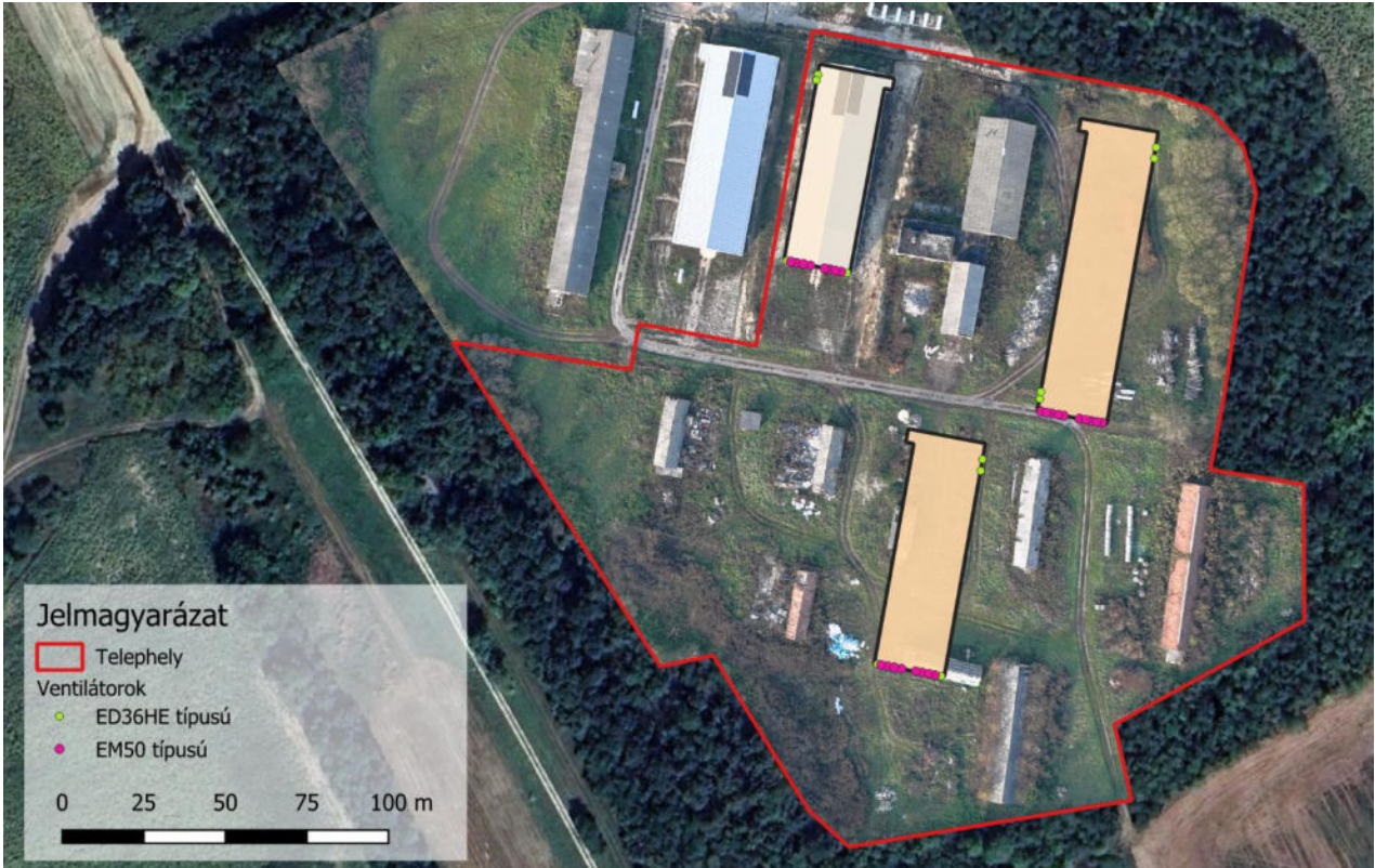
7. ábra Ventilátorok elrendezése
