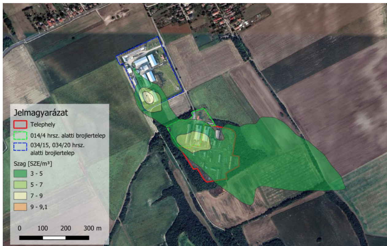
6. ábra A környező állattartó telepek szagkibocsátása – terjedési kép
