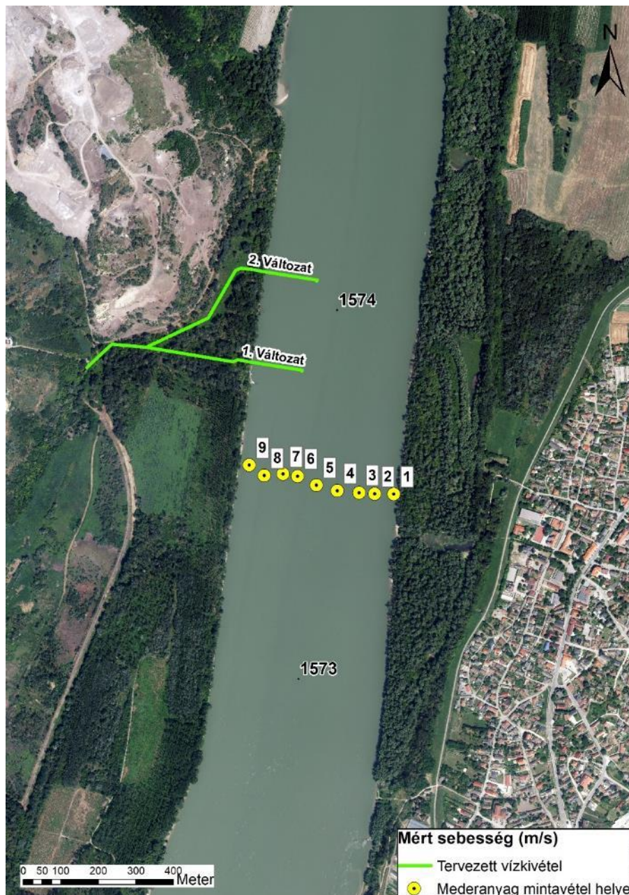
48. ábra: A fenékcúszató feszültségek megállapításához használt mérési pontok.
