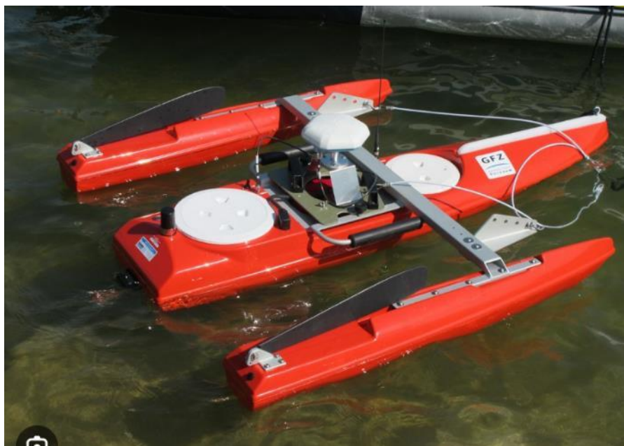
26. ábra: Teledyn WorkHorse Rio Grande 600 kHz vízhozam-mérőberendezés.
