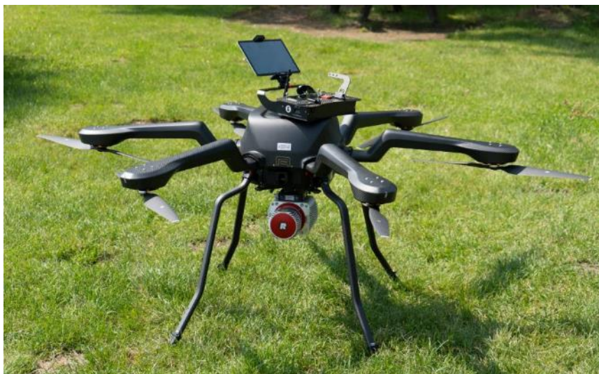
13. ábra: Acecore Noa drón Riegl VUX-1LR légi lézerszkennerekkel.
