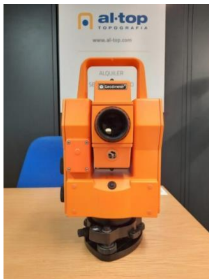
24. ábra: Geodimeter 610 SR.
