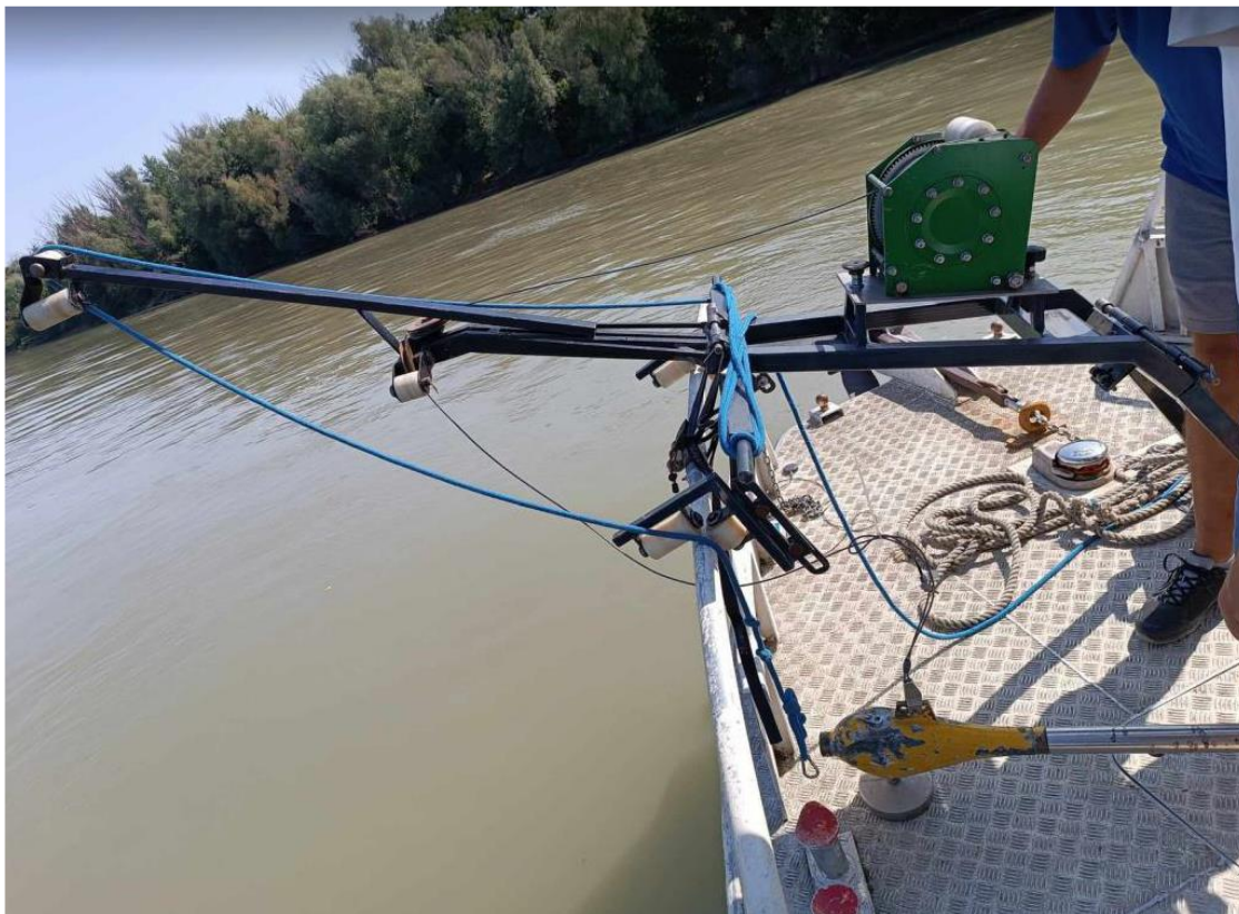
28. ábra: Lebegtetett hordalék mintavételezése (szívócső a merülő súlyra szerelve).
