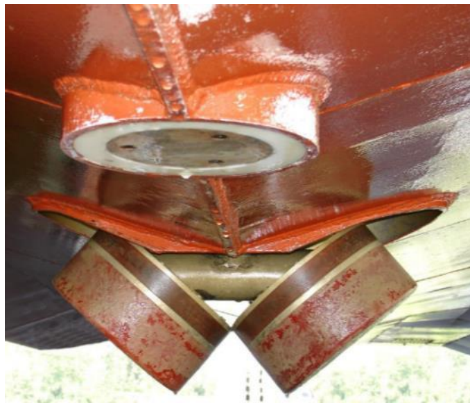
23. ábra: Egy és többsugaras ultrahangos mélységmérő (Multibeam).
