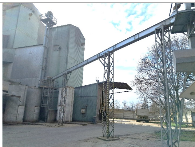
26. Kép: Rédler a garatból a keverőtornyba
