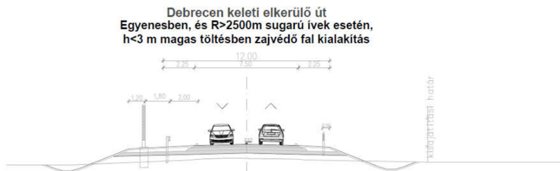
3. ábra Mintakeresztmetszely – tervezett Debrecen keleti elkerülő zajárnyékoló fal kialakítással
