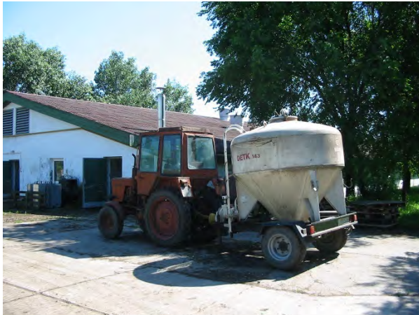
MTZ-80 tip. traktor és DETK 143 típusú mobil tartálykocsi
