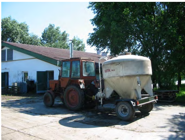
MTZ-80 típ. traktor és DETK 143 típusú mobil tartálykocsi
