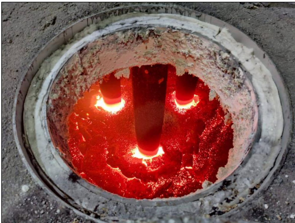
9. sz. ábra: Merülő ívkemence belső tere elektródákkal
