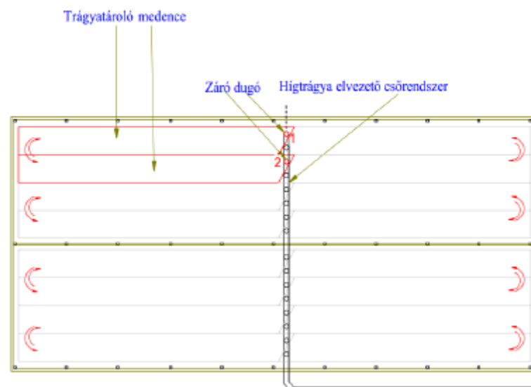
14. ábra Váltakozó duzzasztáson alapuló hígtrágyaelvezetés ábrája
