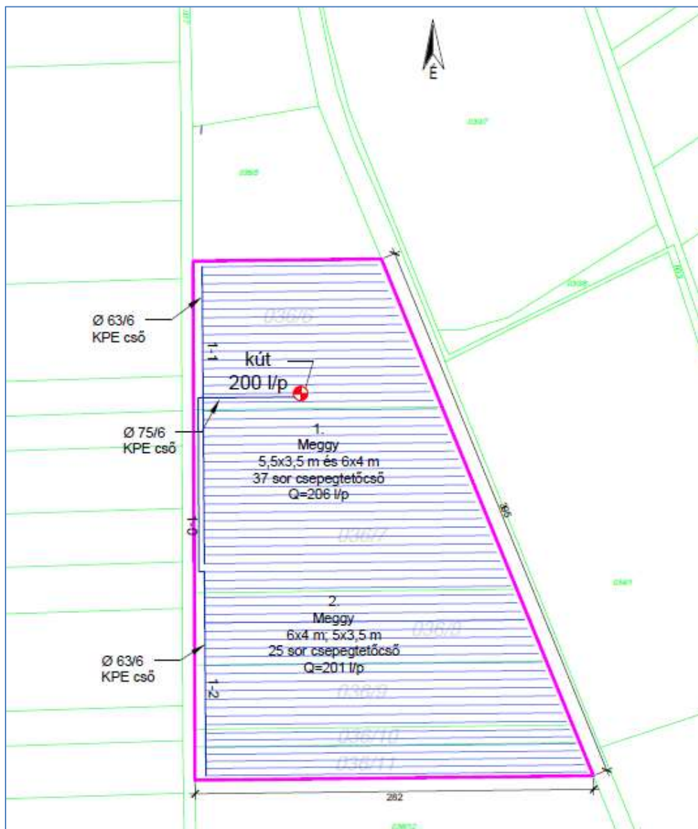
5.kép: Az öntözőtelep öntözési blokkjainak helyszínrajza. Forrás: Áramlás Kft., Csepegtető Öntözőtelep Engedélyezési Tervdokumentációja, 2025. 12. 01.
