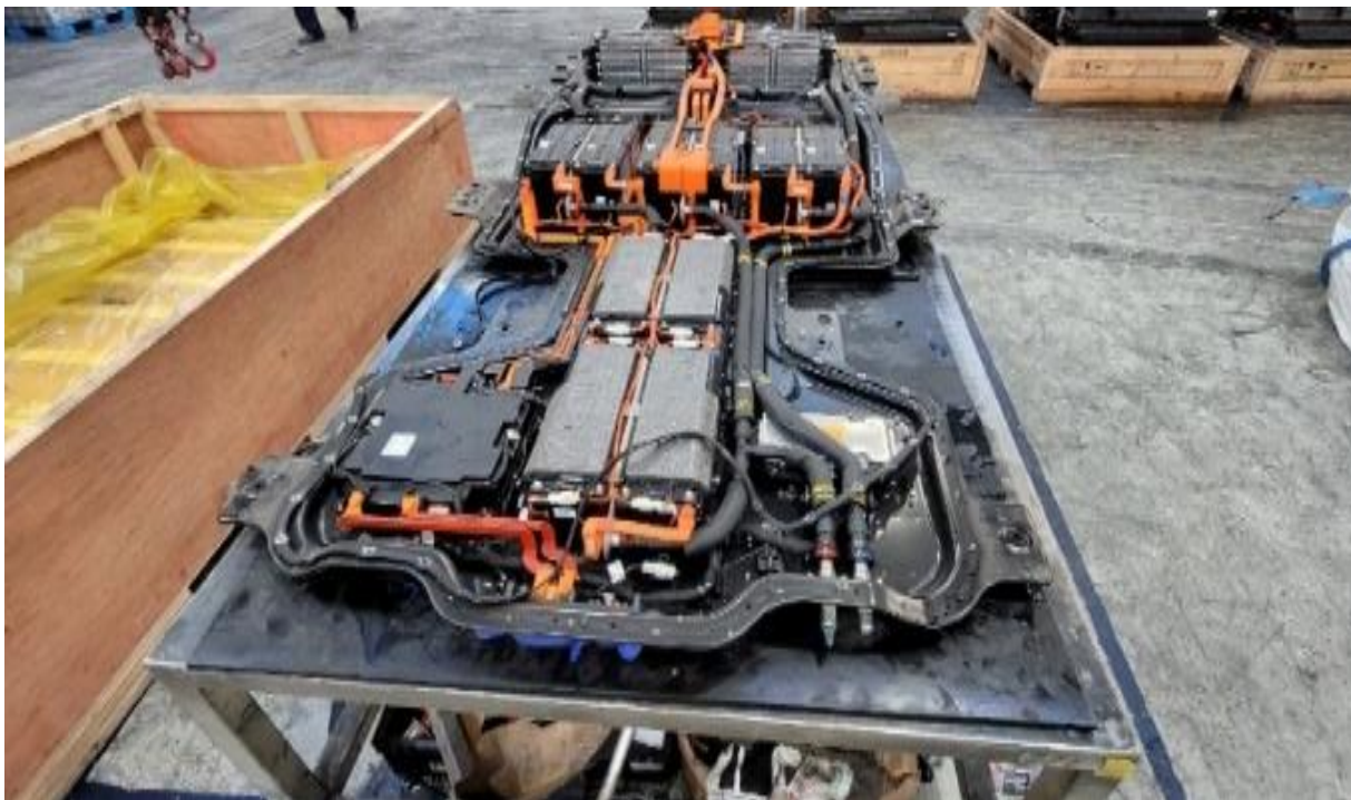
16. ábra: Szétszerelés alatt álló akkumulátorpack
