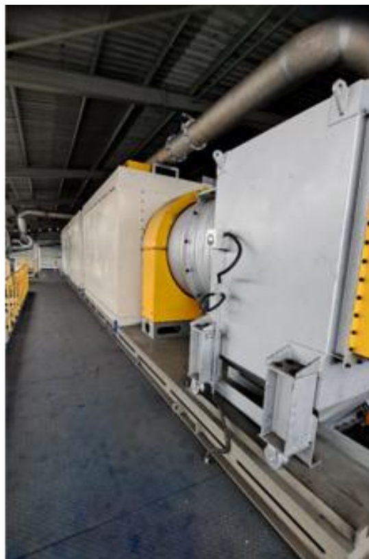
22. ábra: A forgó dobszárító szárítóegysége
