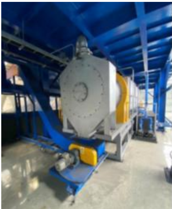
23. ábra: A forgó dobszáritó hűtőegysége és a hozzá tartozó hőszivattyúk
