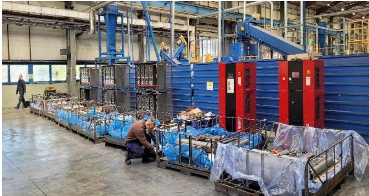
15. ábra: Az akkumulátorpack lemerítésének folyamata
