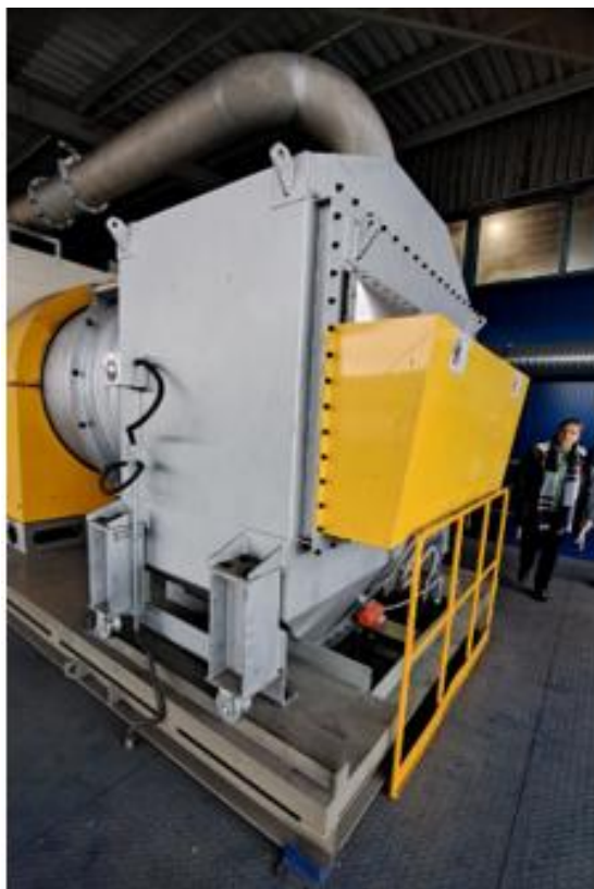
22. ábra: A forgó dobszárító szárítóegysége
