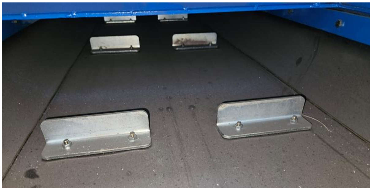
19. ábra: A szállítószalag fogazott beadagoló szakaszának fotója
