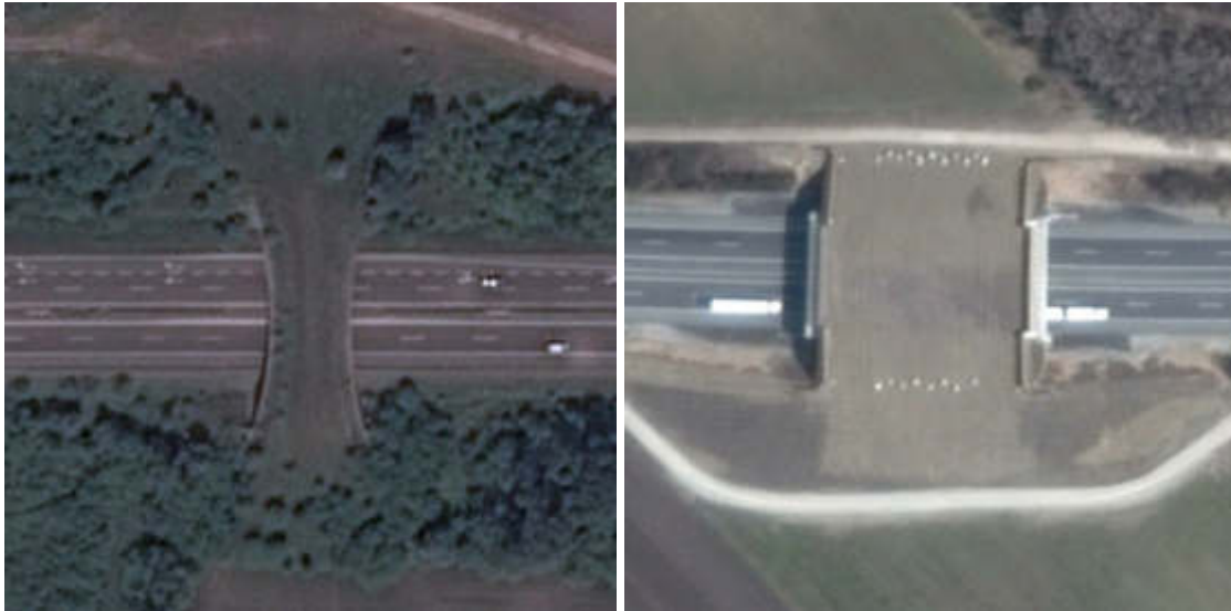
Két nagyvadátjáró út felett azonos méretarányban, bal oldalon: az M7-es autópályán Balatonboglárnál (144+650 km sz.) 20 m széles homokóra forma; jobb oldalon: Ausztriában az A3 autópályán Steinbrunnál 50 m széles kivitelben, a magyar határtól kb. 15 km-re (Google Térkép)
