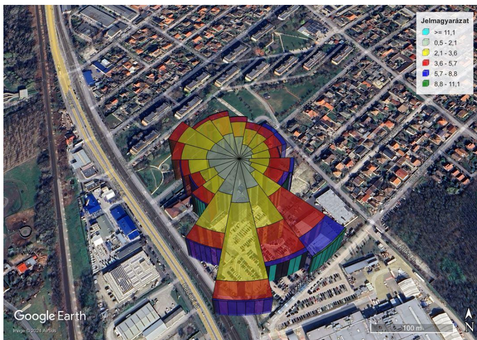
3. ábra. A WRF modellrendszerrel a vizsgált területre kapott felszínközeli szélsébségek transport szélirány szerinti megoszlása (2.) (forrás: Google Earth)
