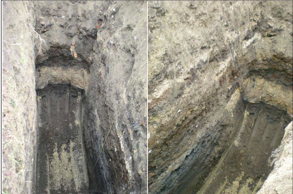
4. fotó: az R4 talajfeltáró fúrás helyén létesített kutatóárok, salakos-törmelékes feltöltés(3,0 m-ig) – barna agyagos iszap(3-3,5 m) – világosbarna iszap(3,5 m-től)
