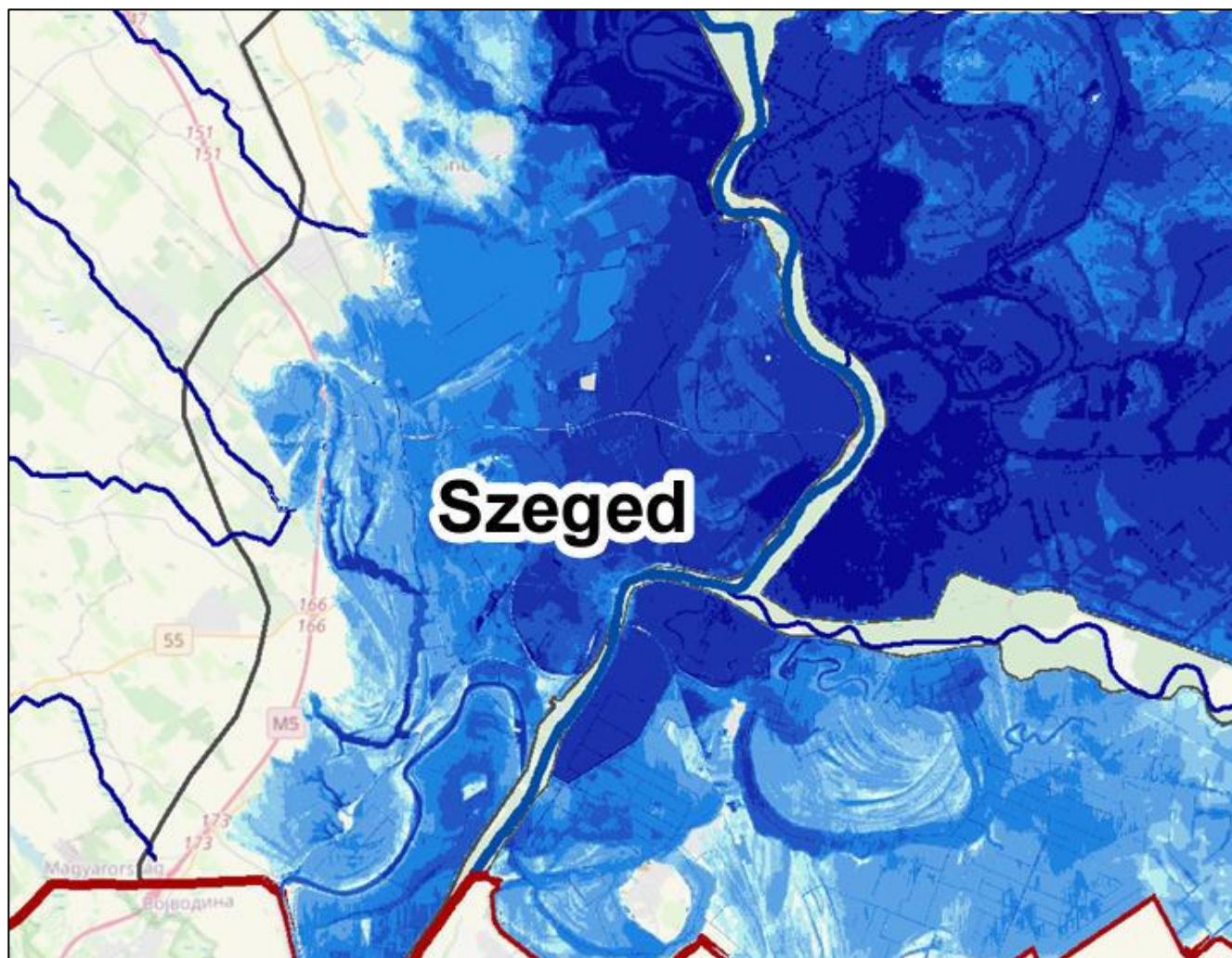
5.2.4. ábra: 1000 éves (0,1%) valószínűségű elöntési térkép (forrás: chrome-extension://efaidnbmnnnibpcajpcgclefindmkaj/https://vizeink.hu/wp-content/uploads/2022/12/akk/Ertekeles_AT_Hmax_1e_DDP.pdf )
