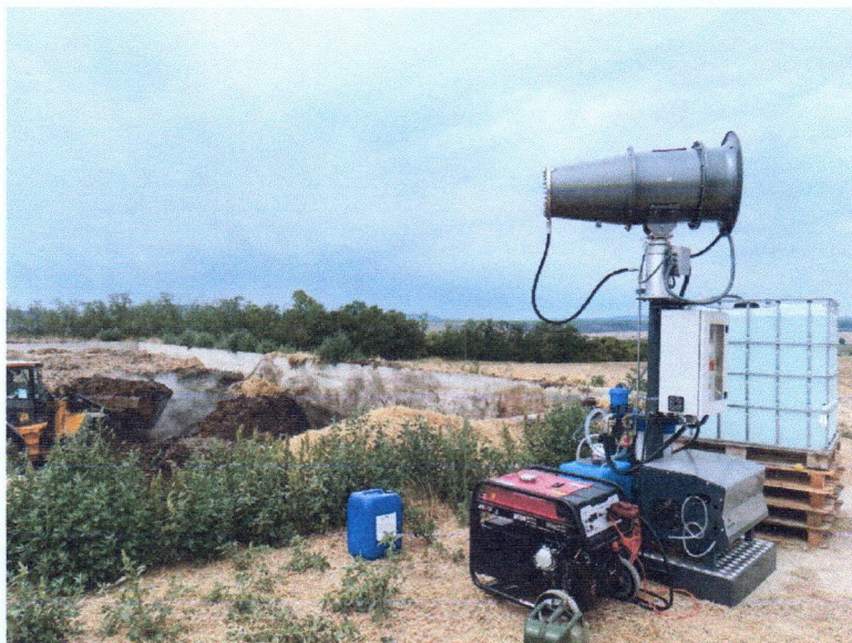
1. ábra: Mobil szagtalanító eszköz oszlopra szerelve egy trágyatároló mellett elhelyezve (áramfejlesztővel és víztartállyal)
