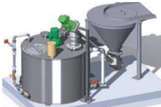
16.sz. ábra. Sodimat mésztej bekeverő egység
