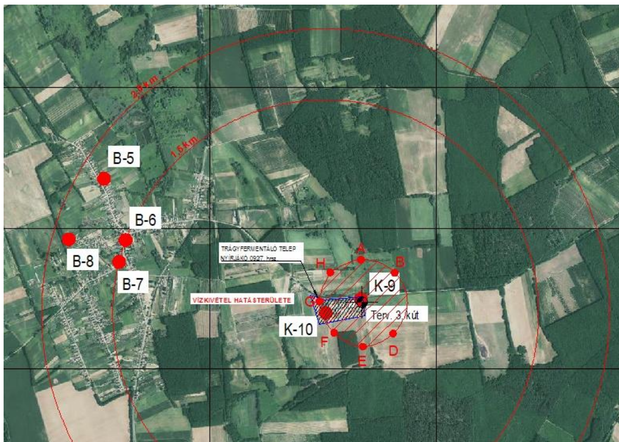
2. ábra: Nyírbákó trágyafermentáló telephely tervezett 3.számú kút felszín alatti vízkivételének 30 cm-es vízszintsüllyedéshez tartozó hatásterülete az érintett 2. számú modellrétegben
