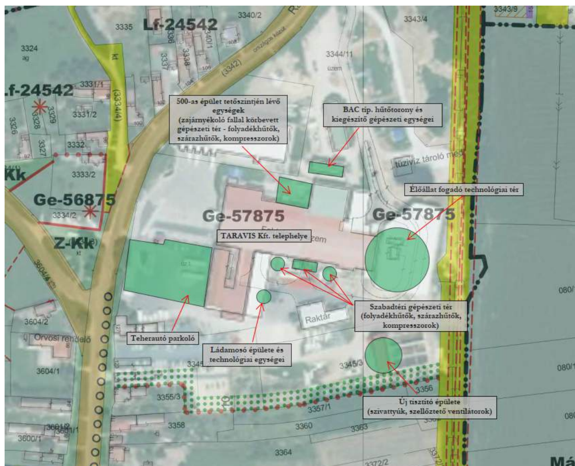
2. ábra: TARAVIS Kft. telephelyén lévő technológiai terek, illetve gépészeti egységek helyei
